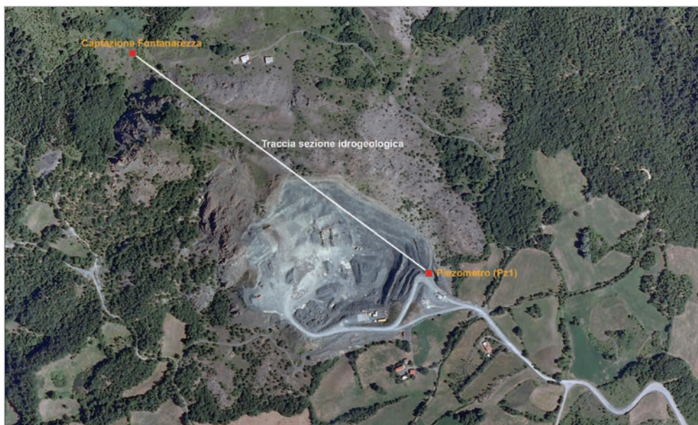
Figura 8 Monte Zirone, ubicazione del piezometro (Pz1), della sorgente basale captata Fontanarezza e traccia della sezione idrogeologica.
