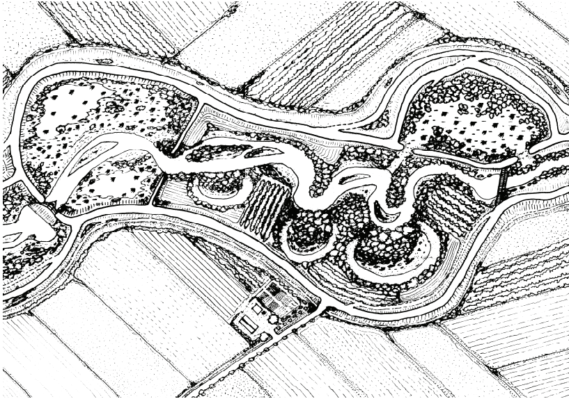
Figura 21 Sistema di casse d'espansione: in derivazione (parte alta della figura) e in linea (parte bassa della figura).
