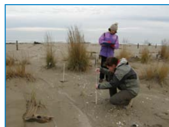
Letture del livello della sabbia lungo un transetto di aste fisse allineate Est-Ovest.
