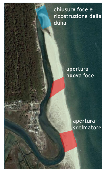
Intervento di sistemazione della foce Bevano. Rappresentazione schematica delle principali aree di intervento
