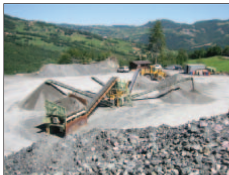
Foto 34 – Frantoio mobile e cumuli di materiale selezionato
