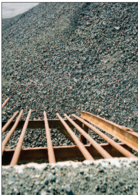
Foto 31 – Vagliatura meccanica statica (griglie) (C. Pedroni)
