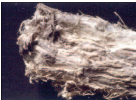
Foto 21 – Particolare di crisotilo, amianto di serpentino
