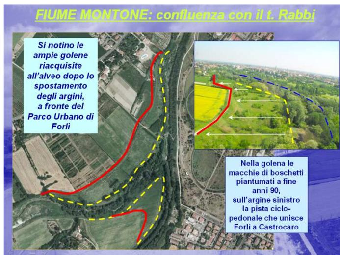
La realizzazione di tali aree di espansione, in particolare quelle ubicate a monte dell'abitato di Forlì, soggetto a rischio idraulico, ha determinato, negli eventi alluvionali successivi, un rallentamento delle onde di piena, grazie ad un assetto del fiume più largo e più incline a laminare le piene piuttosto che a smaltirle velocemente verso valle.
