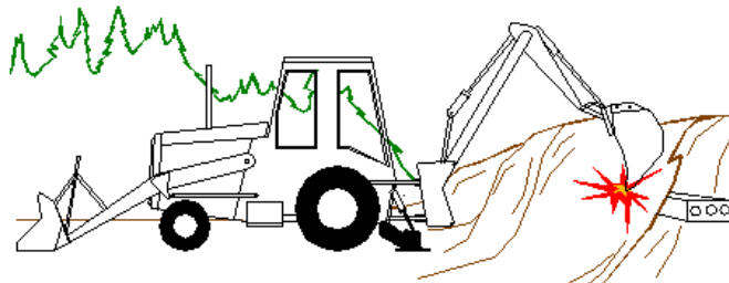
Figura 1 – Contatto con linee elettriche interrate
