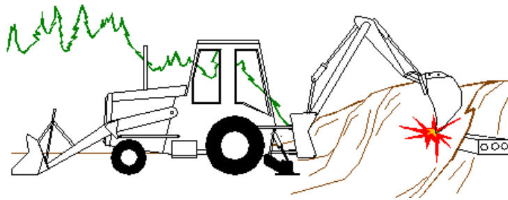
Figura 1 – Contatto con linee elettriche interrata
