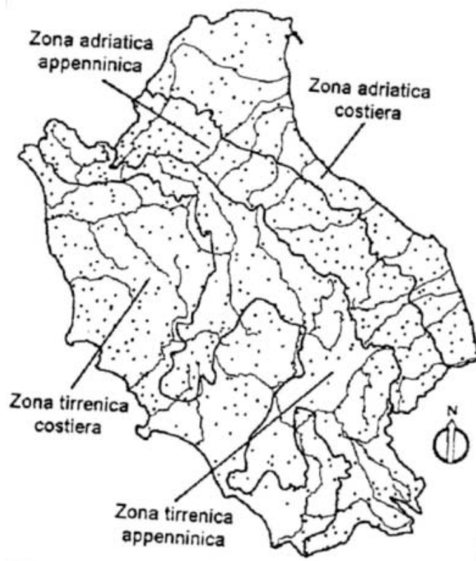
Figura 4 - Modello TCEV per la valutazione delle piogge intense nell'Italia Centro-Settentrionale. Suddivisione dell'area in zone omogenee nei riguardi delle piogge intense.
