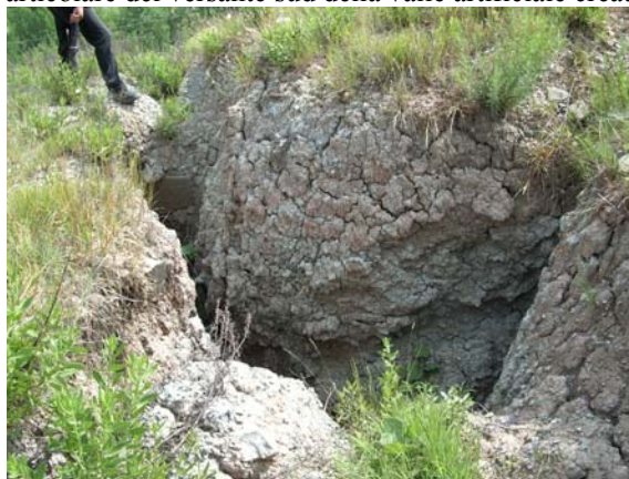
Esempi dei fenomeni di intensa erosione idrica con sottoescavazione nella zona B
