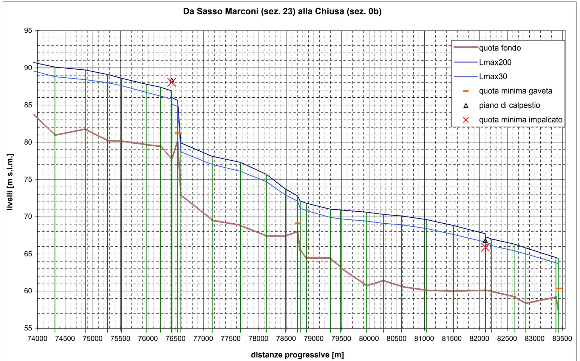
Profilo longitudinale del fiume Reno e involucro dei livelli idrici massimi per TR = 25 e 100 anni, con indicazione delle quote significative di ponti e briglie.
