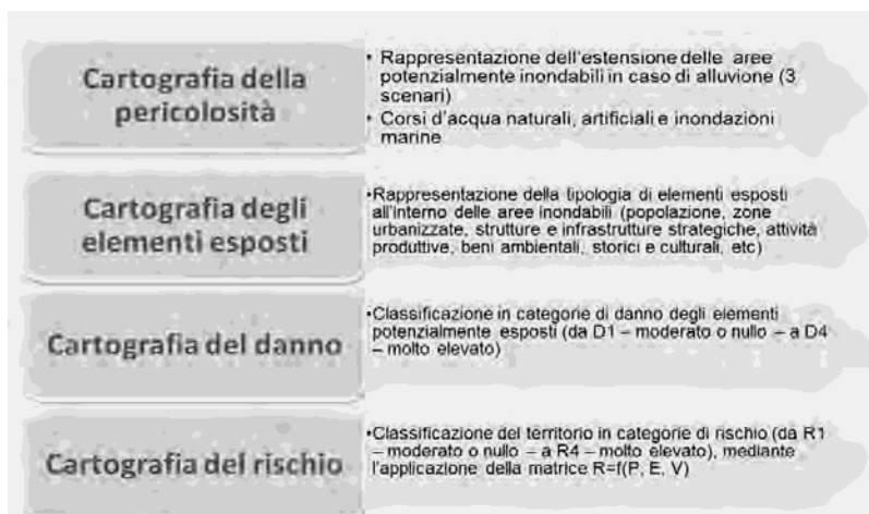
Figura 14. Fasi di definizione delle mappe della pericolosità e del rischio di alluvioni.
