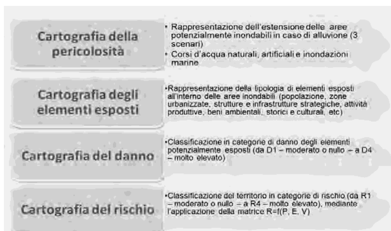
Figura. Fasi di definizione delle mappe della pericolosità e del rischio di alluvioni.
