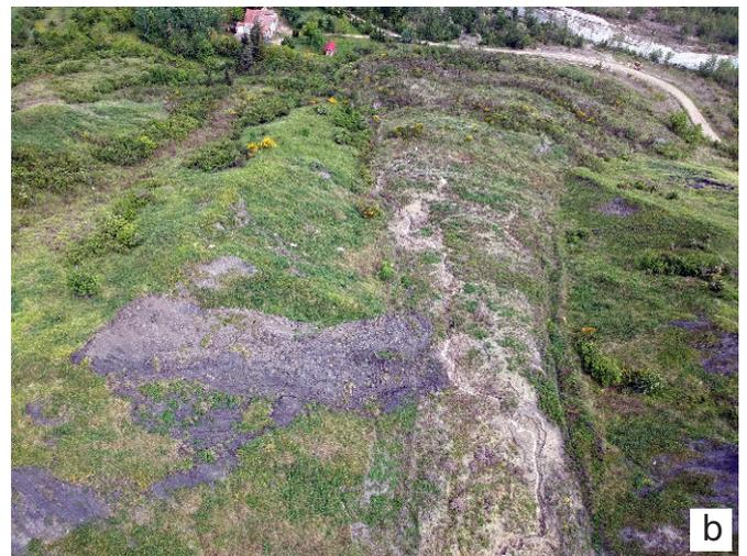
Figura 18 - La colata di fango che ha interessato un versante nei pressi di San Clemente (Casalfiumanese, BO), visione a sinistra del coronamento e a destra del piede della frana. (foto da sopralluogo di UNIBO - Dipartimento BiGeA).
